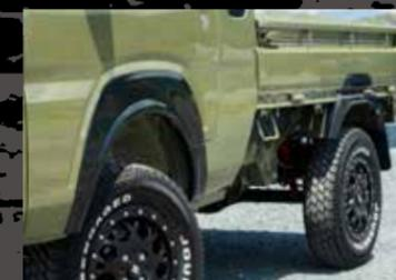
この春、発売が開始されたばかりのニューアイテム、フェンダープロテクター。素材はABS製で厚さは8mm。もちろん、車検もOKだ。
