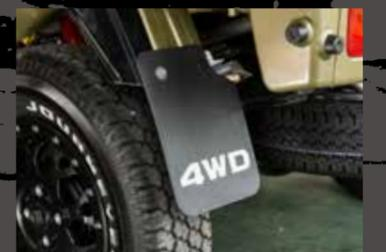
4WDロゴ入りのマッドガード。クロカンマシ的な雰囲気を高めるだけでなく、後方への泥や跳ね石の飛散を防ぐためにも必要なパーツ。
