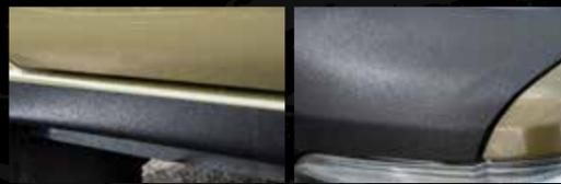
タイヤアーチといった曲面や、ベッドの淵といった細かな部分にもしっかりとコーティングが行き渡る。紫外線にも強いのでエクステリアへの塗布も積極的に行いたい。ザラザラとした仕上がりになるので、タフな雰囲気を感じさせてくれる。
